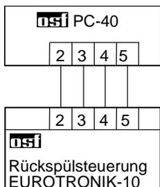
Für den Anschluss der EUROTRONIK-10 ist eine 4-adrige Verbindung erforderlich. Bei dem Anschluss dürfen die Adern nicht vertauscht werden. Die EUROTRONIK-10 benötigt zusätzlich eine separate Spannungsversorgung.
