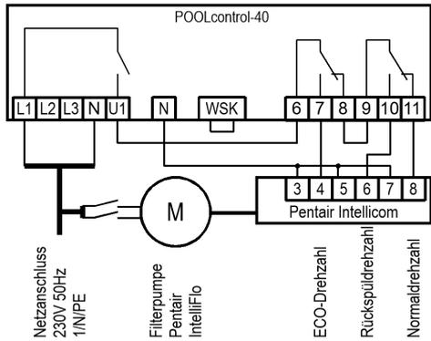
Eine IntelliFlo Pumpe kann mit Hilfe der Pentair Intellicom-Steuerung von der PC-40 angesteuert werden.
