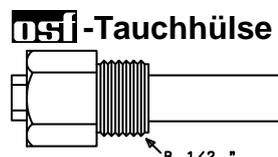
Da eine exakte Temperaturregelung nur bei gutem Wärmeübergang zwischen Temperaturfühler und Schwimmbadwasser erfolgt, ist eine **DSI**-Tauchhülse R 1/2 " (Art. Nr. 320.020.0003) in das Rohrleitungssystem einzubauen.
