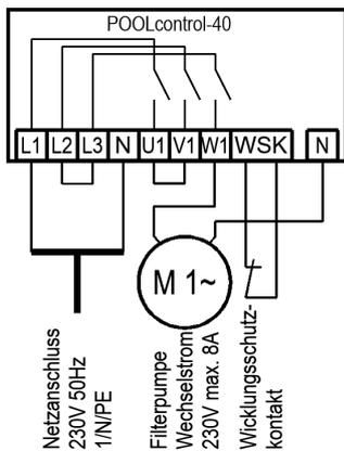
Falls eine 230V-Pumpe durch den elektronischen Motorschutz überwacht werden soll, muss für die Filterpumpe die Option **Filterpumpe - Typ: Drehstrompumpe** gewählt werden. Der Auslösestrom des Motorschutzes muss auf den Nennstrom der Pumpe (sh. Typenschild) eingestellt werden. Damit der elektronische Motorschutz korrekt arbeitet, muss der Motorstrom über alle 3 Schaltkontakte der Filtersteuerung geführt werden (Klemmen L2 und L3 sowie U1 und V1 überbrücken, Pumpe an W1 anschließen).
