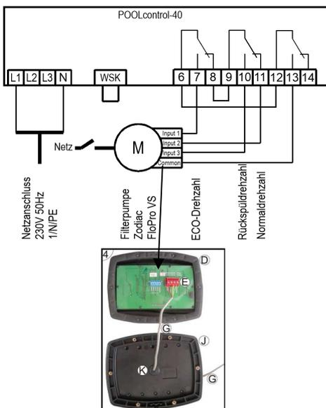
Eine Zodiac FloPro VS Pumpe kann direkt an die PC-40 angeschlossen werden. Die Drehzahlsteuerung wird an die Klemmen 6-12 angeschlossen.
