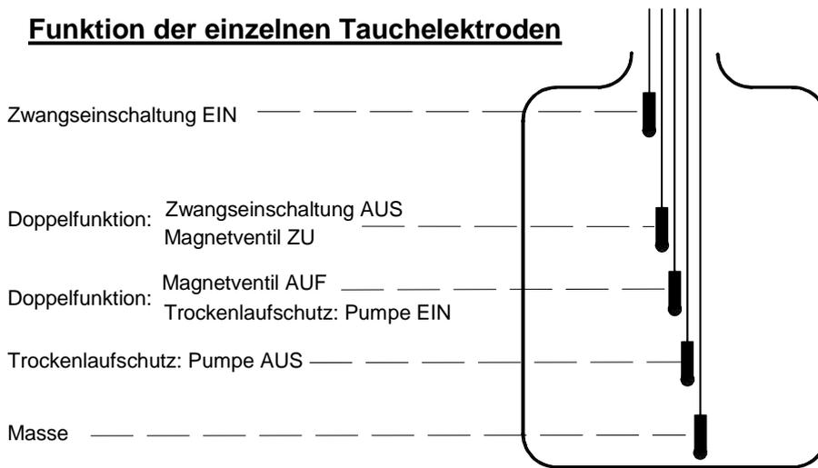
Im Normalbetrieb pendelt der Wasserstand zwischen den Elektroden "Magnetventil ZU" u. "Magnetventil AUF"
