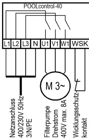
Die werksseitig eingefügte Brücke zwischen den beiden Klemmen WSK muss bei Anschluss einer Pumpe mit Wicklungsschutzkontakt entfernt werden. Falls die Pumpe keinen Wicklungsschutzkontakt hat, muss sie eingeschraubt bleiben. Diese Klemmen führen Netzspannung!
