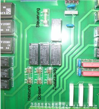
Die elektronische Steuerung ist durch eine 0,5A Feinsicherung auf der Leiterplatte im Inneren des Gerätes abgesichert. Für Heizung, Dosier-technik und Zusatzausgang ist jeweils eine 3,15A Feinsicherung vorhanden. Der Kurzschluss-Schutz für die Filterpumpe ist durch bauseitige Vorsicherungen von max. 16A sicherzustellen.
