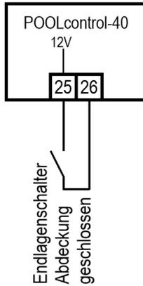
An die Klemmen 25 und 26 kann ein Endschalter der Schwimmbadabdeckung angeschlossen werden, der bei geschlossener Abdeckung automatisch den ECO-Betrieb startet. Die Klemmen führen Sicherheitskleinspannung.
