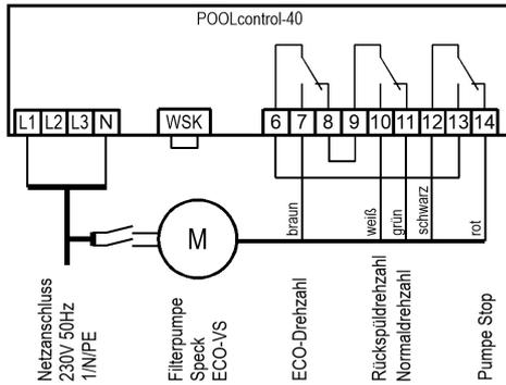
Eine Speck ECO-VS Pumpe kann direkt an die PC-40 angeschlossen werden. Die Drehzahlsteuerung wird an die Klemmen 6-14 angeschlossen.
