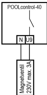
Für den Wasserzulauf ist ein stromlos geschlossenes Magnetventil zu verwenden. Dieses wird an die Klemmen U9 / N der Steuerung angeschlossen. Ein geeignetes Magnetventil (R1/2“) ist unter der Artikel-Nummer 1090005804 aus dem **DSI** Programm zu beziehen.
