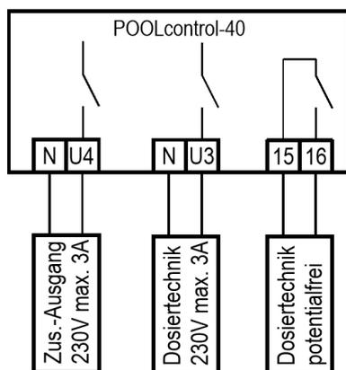
An Klemme U4 kann ein 230V-Zusatzgerät (z.B. Unterwasser-Scheinwerfer) angeschlossen werden, das mit einer eigenen Schaltuhr in der Steuerung beliebig ein- und ausgeschaltet werden kann. Da dieser Ausgang konfigurierbar ist, kann er auch zur Steuerung einer Flockungspumpe verwendet werden.
