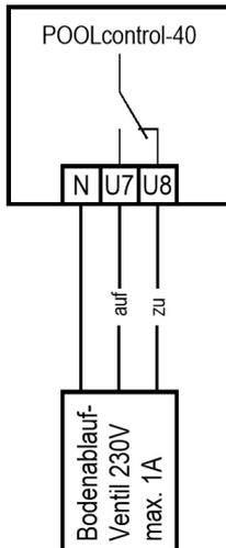
An die Klemmen U7 und U8 kann ein Bodenablauf-Ventil (ECO-Ventil) oder ein Ventil zur seitlichen Wasserentnahme angeschlossen werden. Ein 2-Wege-Ventil wird an die Klemmen U7 und N angeschlossen. Bei einem 3-Wege-Ventil wird die Klemme U7 für „AUF“ und die Klemme U8 für „ZU“ verwendet. Dieser Kontakt kann mit max. 230V/1A belastet werden.
