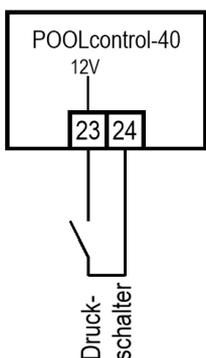
An die Klemmen 23 und 24 kann ein Druckschalter angeschlossen werden, der in der Druckleitung oder im Manometeranschluss des Zentralventils installiert wird. Wenn der potentialfreie Kontakt des Druckschalters mindestens 10 Sekunden geschlossen ist, startet der Rückspülvorgang.
