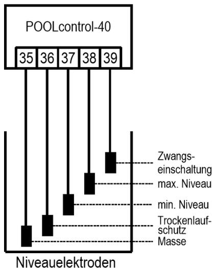
Als Sensoren sind **ISI** Tauchelektroden zu verwenden.
