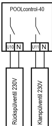
An die Klemmen U10 und N kann ein 230V Stangenventil für Rückspülen angeschlossen werden.
