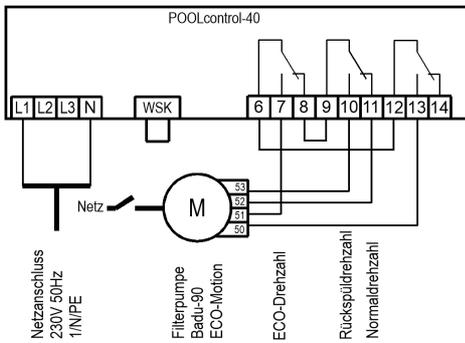
Eine Speck Badu-90-ECO-Motion Pumpe kann direkt an die PC-40 angeschlossen werden. Die Drehzahlsteuerung wird an die Klemmen 6-13 angeschlossen.
