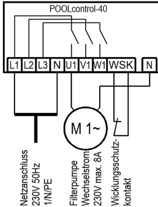
Die werksseitig eingefügte Brücke zwischen den beiden Klemmen WSK muss bei Anschluss einer Pumpe mit Wicklungsschutzkontakt entfernt werden. Falls die Pumpe keinen Wicklungsschutzkontakt hat, muss sie eingeschraubt bleiben. Diese Klemmen führen Netzspannung!
