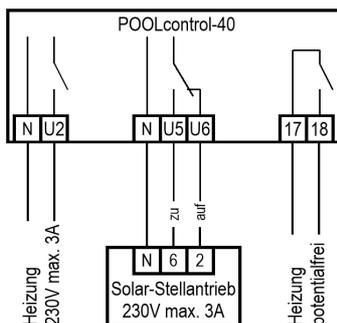
Die Schwimmbadheizung kann an der Klemme U2 angeschlossen werden. Dieser Ausgang liefert 230V und kann bis max. 3A belastet werden.
