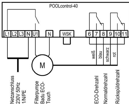
Eine Speck ECO-Touch Pumpe kann direkt an die PC-40 angeschlossen werden. Die Drehzahlsteuerung wird an die Klemmen 6-11 angeschlossen.
