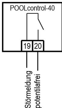
An die potentialfreien Klemmen 19 und 20 kann eine externe Störmeldung angeschlossen werden. Dieser Kontakt kann mit max. 230V/4A belastet werden.
