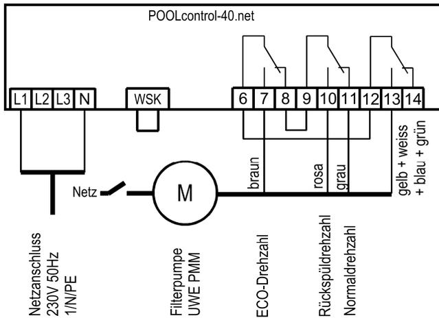
Eine UWE PMM Pumpe kann von der PC-40 angesteuert werden.
