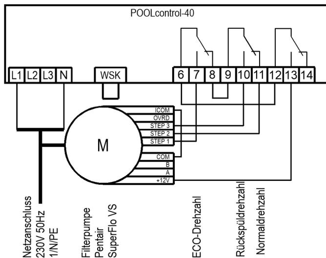
Eine SuperFlo VS Pumpe kann von der PC-40 angesteuert werden.
