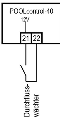
Statt der werksseitig zwischen den Klemmen 21 und 22 eingefügten Brücke kann ein Durchflusswächter oder ein Druckwächter angeschlossen werden, um die Pumpe zusätzlich vor Trockenlauf zu schützen. Sein Kontakt muss im Filterbetrieb spätestens 10 Sekunden (Werkseinstellung, Einstellbereich 5-60 sek.) nach Anlaufen der Filterpumpe geschlossen sein, sonst wird die Filterpumpe ausgeschaltet und die Störmeldelampe leuchtet auf. Im Rückspülbetrieb wird dieser Kontakt nicht abgefragt.
