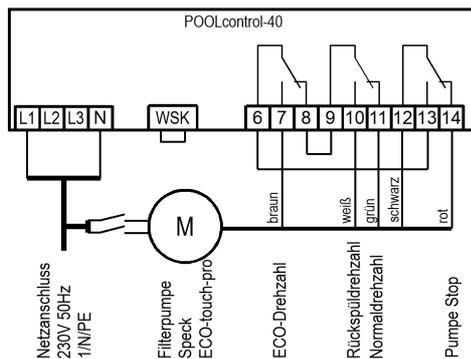
Eine Speck ECO-Touch-Pro Pumpe kann direkt an die PC-40 angeschlossen werden. Die Drehzahlsteuerung wird an die Klemmen 6-14 angeschlossen.
